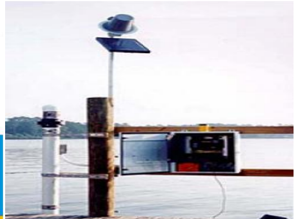
الشكل (٨): صورة لجهاز حساب تغيرات المد و الجزر
